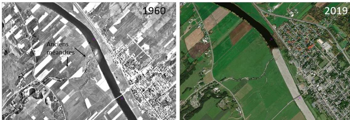
Figure 9: Embouchure de la rivière des Fermes à St-Joseph-de-Beauce en 1960 et 2019. Les anciens méandres de la rivière des Fermes sont visibles sur la photographie de 1960, de même que l'accumulation de sédiments qui ont été dragués en 1965. À noter que cette accumulation est aussi visible sur les photos de 1979 et est toujours présente.
